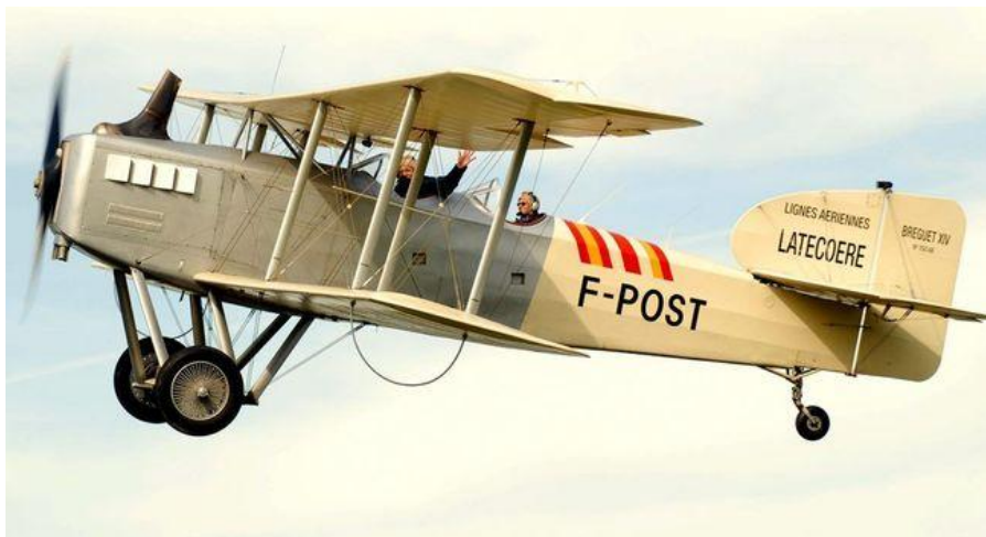
Bréguet XIV pour le bombardement (300 CV - 32 bombes de 10 kg)
